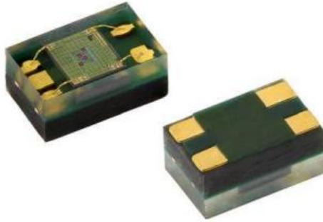
**VEML6040**是颜色传感器可感测红光、绿光、蓝光和白光，并将光电二极管、放大器和模拟/数字电路集成到单个CMOS芯片中。这种数字RGBW信息可用于反馈控制系统等，以监测和主动控制光源。例如，应用颜色微传感器后，可以根据环境光条件调整背光的亮度和色温，使面板看起来更舒适。
