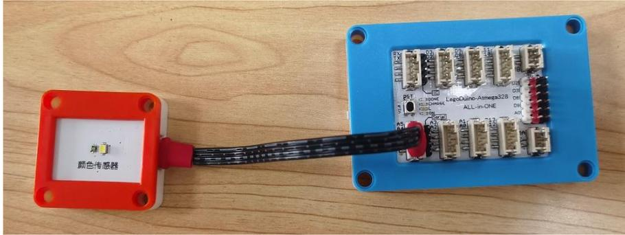
彩灯模块的 G、V、NC(空引脚)、S 分别连接 主板的GND、VCC、D9引脚。
